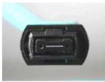
QSFP+ポート2個を直接接続するために、12心のケーブルの両端でピンなしのMTPコネクタを使用して、スイッチのQSFP+ポートとのインターフェイスとしています(ピンはトランシーバー・ポートにあります)。下の図の例では、ファイバー1(青色)は、一方の端では1番の位置にあり、もう一方の端では12番の位置にあります。送信と受信の接続のために、この配置が必要です。この構成の部品番号は次の表のとおりです。
