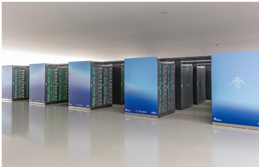
そもそもスーパーコンピュータの接続回線はどのような役割を担っているのでしょうか。スーパーコンピュータの演算性能を活かすために、データアクセスがボトルネックにならないように計算に必要なデータはあらかじめ「富岳」側の高速ストレージにコピーしておき、超高速な内部インターコネクトを介して読み書きしています。SINETとの外部接続回線は、ユーザーのデータを「富岳」のストレージにコピーするために利用される形になります。
