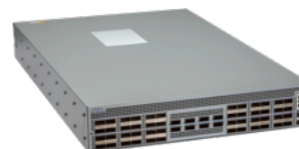
Arista 7050CX4M-48D8: 48x 100G QSFP-100 ports, 8x 400G QSFP-DD
