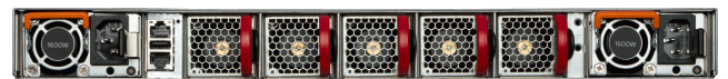
Arista 7060X4シリーズの背面：前面吸気/ 背面排気のエアフロー
