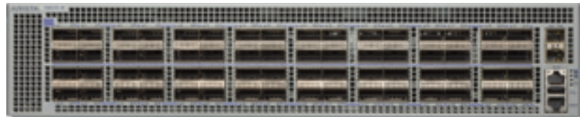
Arista 7260CX3-64: 40/100GbE QSFP100 포트 64개, 2 SFP+ 포트 2개
