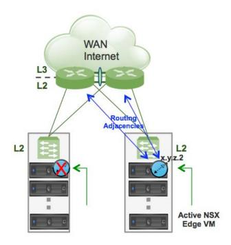
Figure 17. Failure of Active Edge
