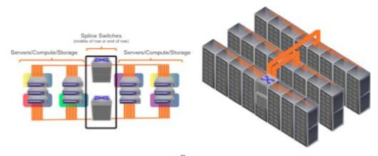
Figure 5. Spline<sup>™</sup> Switch Placement
