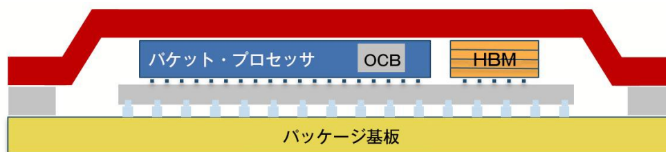
図 15: HBM のメモリ・パッケージング統合
