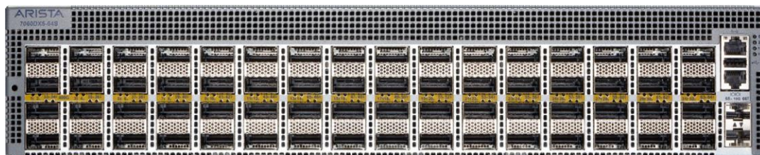
図 11: Arista 7060DX5-64S:64 の 400GbE QSFP-DD ポート、2 つの SFP+ポート
